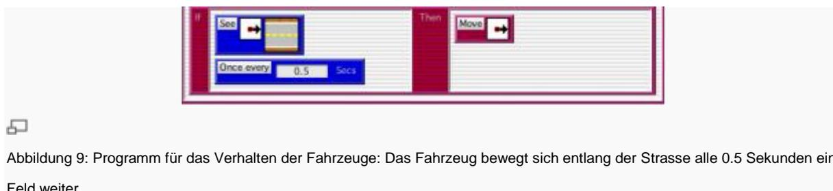
Abbildung 9: Programm für das Verhalten der Fahrzeuge: Das Fahrzeug bewegt sich entlang der Strasse alle 0.5 Sekunden ein Feld weiter.
